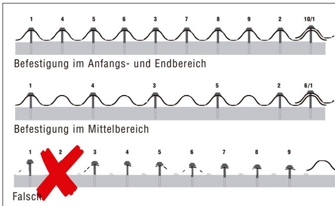
Um die Deckbreite während der Befestigung nicht zu verändern, müssen zunächst der erste, der vorletzte und der mittlere Wellenberg befestigt werden (siehe Abbildung).
