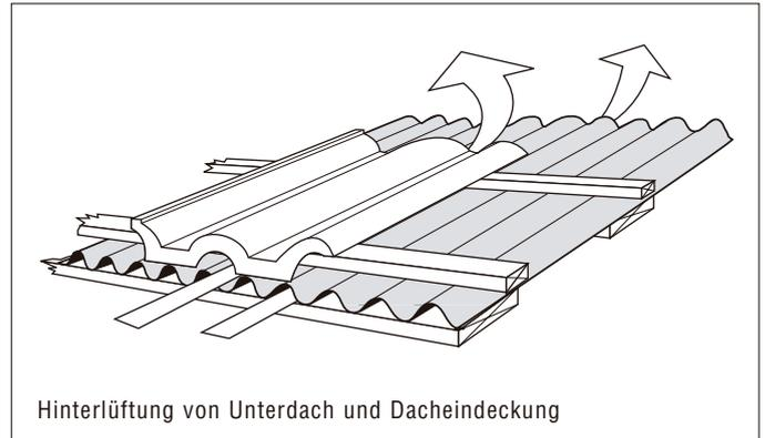
Hinterlüftung von Unterdach und Dacheindeckung
