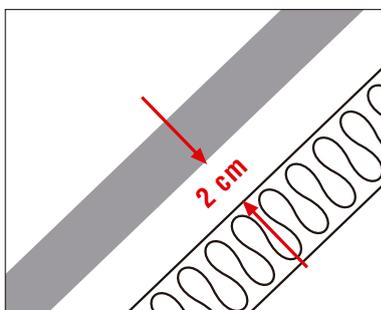
Die freie Lüftungshöhe muß mindestens 2 cm betragen und darf durch Einbauten (z.B. Gauben, Fenster, Wechsel usw.) nicht behindert werden. Dämmschichten sind raumseitig möglichst winddicht auszubilden.
