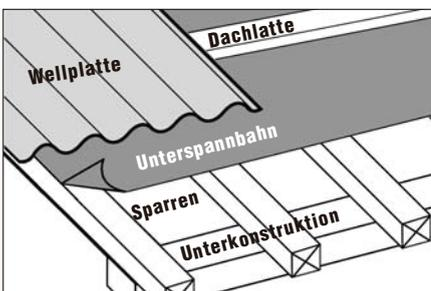
Bei Fahrzeug-Unterstellplätzen mit Onduline-Dach- und Wandplatten-Eindeckung sind Dachneigungen ab 7° möglich.
