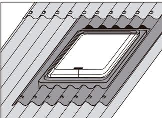
Der Onduline-Dachausstieg ist zum Ausstieg, zur Belichtung und Belüftung nutzbar. Dieses Kunststoffelement hat eine gewellte Bodenplatte und wird auf jedem Wellenberg genagelt. Die Seiten- und
