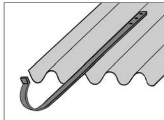
Die handelsüblichen Leiterhaken werden im Bereich der Höhenstossüberdeckungen montiert. Unter der Befestigungsstelle ist eine zusätzliche Dachlatte erforderlich.
