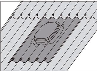
Der Onduline-Flächendachentlüfter für Onduline-Dacheindeckungen ist aus Kunststoff, hat fünf Wellen und ist durch die Konstruktion flugschnee- und treibregensicher.
