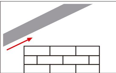
Der freie Lüftungsquerschnitt an der Traufe muß mindestens 2 % der zugehörigen geneigten Dachfläche betragen, mindestens jedoch 200 cm<sup>2</sup>/m.
