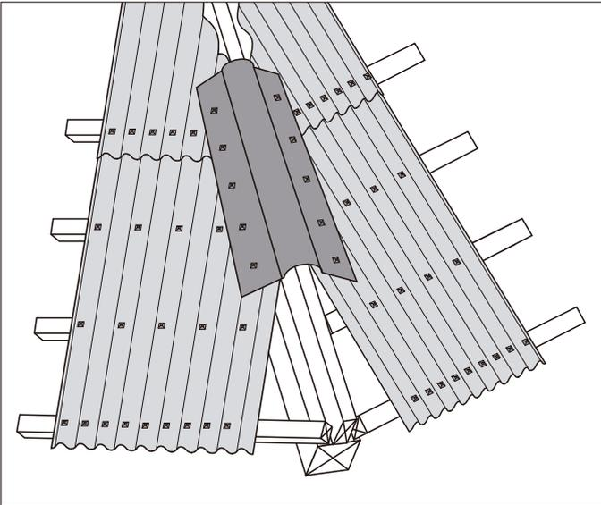
Die Firsthauben (Grathauben) werden beidseitig der Gratlinie auf jedem Wellenberg befestigt. Das kann Hilfskonstruktionen, wie z.B. zusätzliche Latten oder Auflager erforderlich machen.
