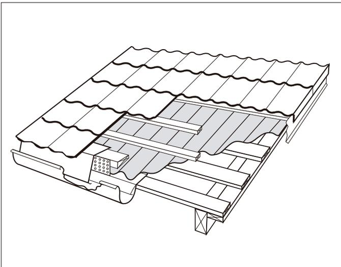
Das Ondutherm-Unterdachsystem bietet als zweite wasserableitende Dachschaale Sicherheit gegen Treibregen, Flugschnee, Sand und Staub und zusätzlich eine hervorragende Hinterlüftung, sowohl der oberen Eindeckung als auch des Unterdaches.
