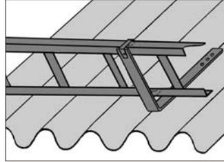
Die handelsüblichen Schneefangstützen werden nahe der Traufe angebracht. Die Schneefangstützen werden grundsätzlich auf dem Wellenberg montiert und mit Schrauben befestigt. Unter der
