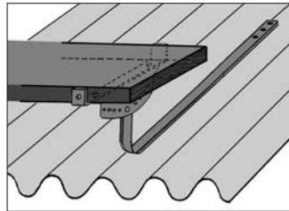
Die handelsüblichen Laufbrettstützen mit verstellbarem Auflagebügel werden parallel zur Traufe montiert. Laufstege können mit Bohlen oder Gitterroste hergestellt werden.
