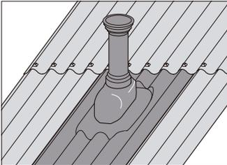
Onduline-Rohrentlüfter sind Kunststoffelemente bestehend aus der gewellten Grundplatte und dem Rohrstutzen. Die Seiten- und Höhenüberdeckung ist im Element vorgesehen.
